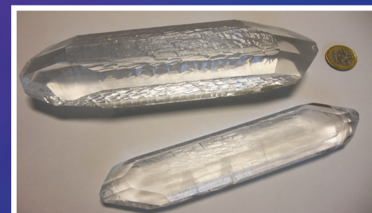
Cristalls de quars sintètic © LMGP-Grenoble-INP
